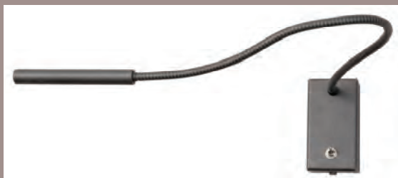
Réf. Applique patère rectangulaire ACOBREC Patère : Long. 8,5cm Larg. 4,5cm Ep. 2,5cm Flexible : Diam. 7mm - Long. 40cm Réflecteur orientable 360° Diam. 12mm Classe II 1 Led de 5W Blanc chaud 2700°K Interrupteur sur boîtier
